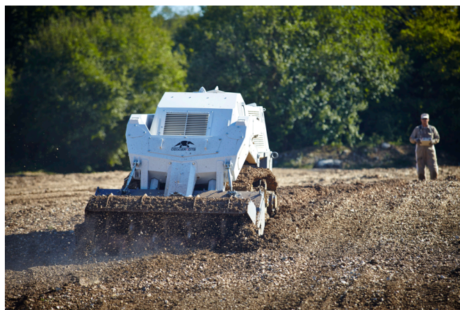
Die neue Generation der humanitären Minenräummaschine Digger D-250, die gepanzert und ferngesteuert ist.
