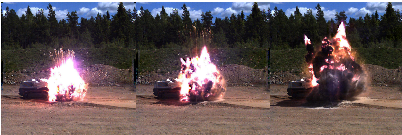
Die Maschine wurde in Schweden an Panzerabwehrminen getestet. Die Explosion war beeindruckend, aber nur das vordere Werkzeug der Maschine wurde leicht beschädigt und sehr schnell repariert.
