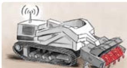
La machine de déminage que nous souhaitons offrir à l'Ukraine est une **DIGGER D-250**. Cette machine entièrement fabriquée dans le Grand Chasseral, à Tavannes, est un engin de 12 tonnes, blindé et télécommandé. Elle est équipée à l'avant de ce que l'on appelle une fraise de déminage.
