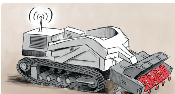
La machine de déminage que nous souhaitons offrir à l'Ukraine est une **DIGGER D-250**. Cette machine entièrement fabriquée dans le Grand Chasseral, à Tavannes, est un engin de 12 tonnes, blindé et télécommandé. Elle est équipée à l'avant de ce que l'on appelle une fraise de déminage.
