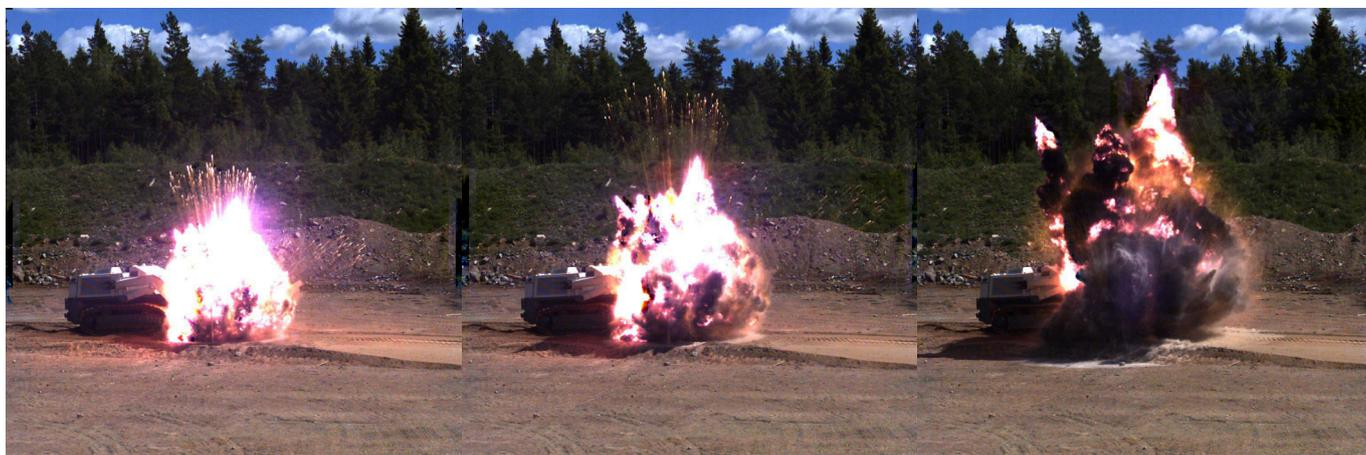
*La machine a été testée en Suède sur des mines antichar. L'explosion est impressionnante mais seul l'outil avant de la machine a été légèrement endommagé et très vite réparé.*
