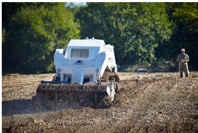
Nouvelle génération de machine de déminage humanitaire blindée et télécommandée Digger D-250
