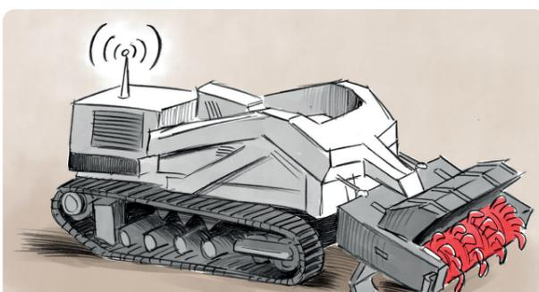
Die Minenräummaschine, die wir der Ukraine schenken möchten, ist eine **DIGGER D-250**, die vollständig in TAVANNES im Grand Chasseral hergestellt wird. Sie ist 12 Tonnen schwer, gepanzert und ferngesteuert. Vorne ist sie mit der sogenannten Minenfräse ausgestattet.
