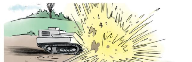
Dieses Werkzeug alleine wiegt über 800 kg und besteht aus einem Rotor mit Grabzähnen, der mit über 7 Umdrehungen pro Sekunde dreht. Damit wird der Boden bis zu 20 cm tief und mitsamt der sich darin befindenden Minen zermalmte. Die problematische Minensuche wird dadurch überflüssig, da die **Minen ganz einfach pulverisiert werden**. Die Minen werden zerstoßen und deaktiviert oder sie werden aktiviert und detonieren. Die Maschine ist so robust, dass sie diese Explosionen übersteht.
